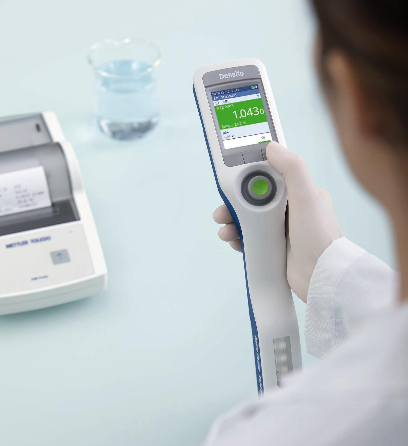
La densidad de un líquido se puede usar como un identificador único en el control de calidad. Garantice la máxima calidad estableciendo un rango de límites aceptables para las muestras: los resultados comprendidos en este rango se codifican con colores, lo que permite identificar al instante las muestras aceptables.
