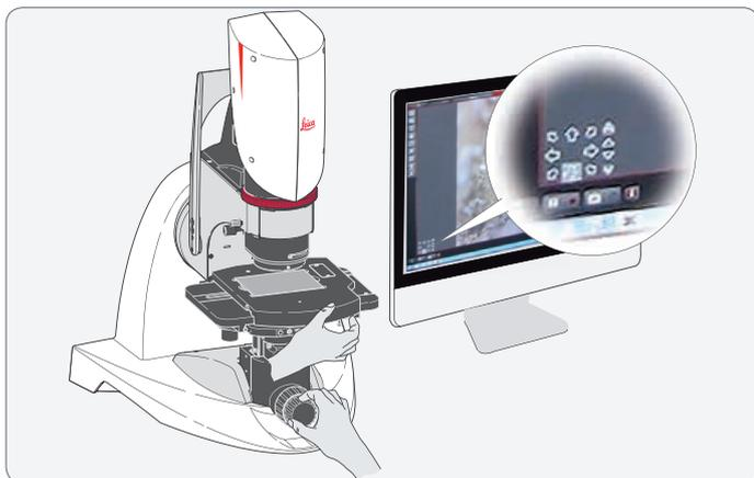
En el Leica DVM6 A (10 450 703), el mando de enfoque y la platina XY están codificados y deben manejarse de forma manual o motorizada.
